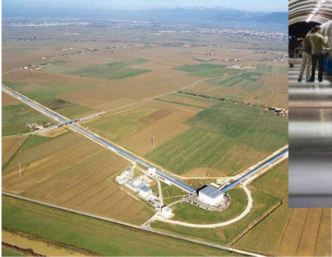
L'interféromètre Virgo et ses deux bras de 4 km à Cascina en Italie Source : CNRS, le journal
